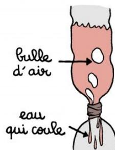
TU REMARQUERAS QU'IL YA DES GROSSES BULLES D'AIR LORS DE L'ÉCOULEMENT DE L'EAU. S' IL Y A DES FUITES D'EAU, REMET DU RUBAN ADHÉSIF ET SERRE PLUS FORT.
